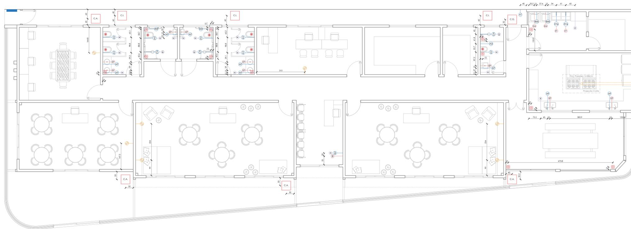
PLANTA DE PONTOS HIDRÁULICOS
