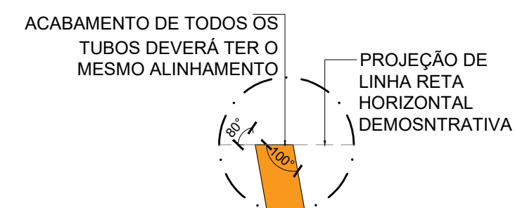
DET. 01 - ACABAMENTO DO TUBO INCLINADO ESC.:1/10
